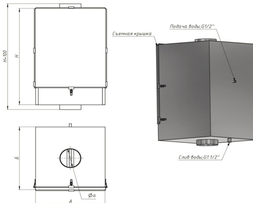
Гидрофильтр изготавливается из нержавеющей стали AISI 430 толщиной 1,2 мм. Гидрофильтр комплектуется разбрызгивателем, сетчатыми фильтрами, лабиринтными фильтрами, кассетами с кольцами Рашига и сантехнической фурнитурой в зависимости от модификации.
